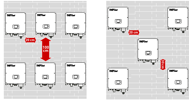
Fig. 33: Mindestinstallationsabstand und Anordnung mehrerer REFUsol 20K...33K-2T
