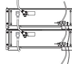
**Schritt 2 :** Spannungswert messen: Nachdem alle Batteriemodule in Reihe geschaltet sind, verwenden Sie ein Multimeter, um die Gleichspannung an der Gleichstromklemme zu messen. Die Gesamtspannung sollte N \*52±10V betragen (N ist die Gesamtzahl der Batteriemodule). Bitte beachten Sie die Abbildung unten für die Spannungsprüfung.
