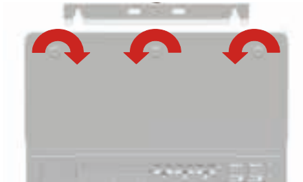
Fig. 19: Schlüsseldreh Sinn zum Öffnen des DC-Anschluss- und -Sicherungsbereichs
