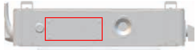
Fig. 20: DC-Anschlussbereich mit Kabeldurchführung
